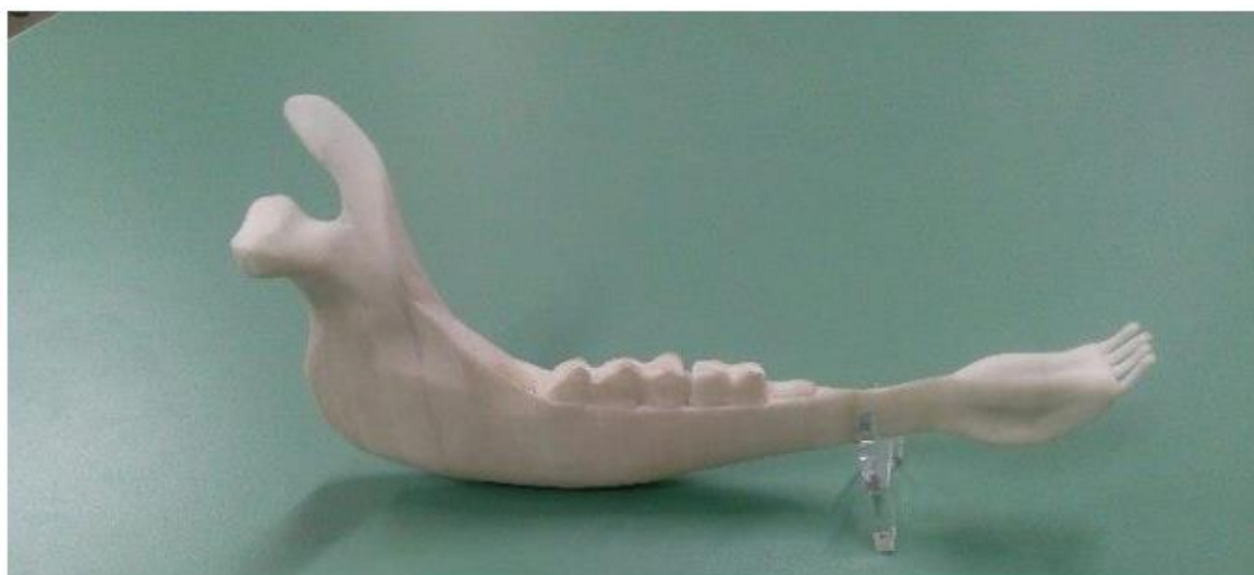
22-сурет-аддитивті технологиялардың көмегімен дайындалған қойдың төменгі жақтың прототипі
